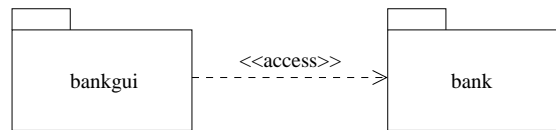
Abbildung 2: 2-Schichten-Architektur für die Bankanwendung
